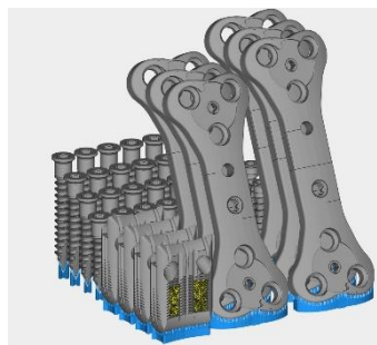
Fabriqués par 3D Medical sur son parc d'imprimantes 3D de GE Additive – MLab100R and MLab200R, les implants en titane (plaques, vis et cages) présentent une forme de côte poreuse et maillée qui permet aux tissus osseux et ligamenteux de bien adhérer à la prothèse. (Photos: 3D Medical, GEADPR059)
