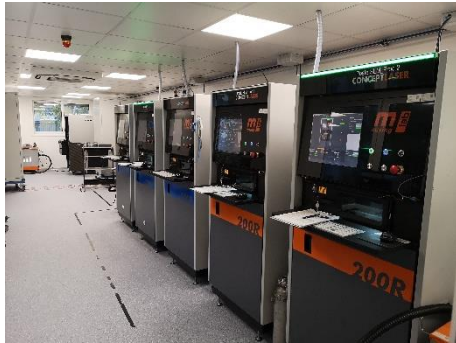
Parc de machines Mlab de GE Additive dans l'atelier d'impression 3D de 3D Medical. (Photos: France Relance, GEADPR059)
